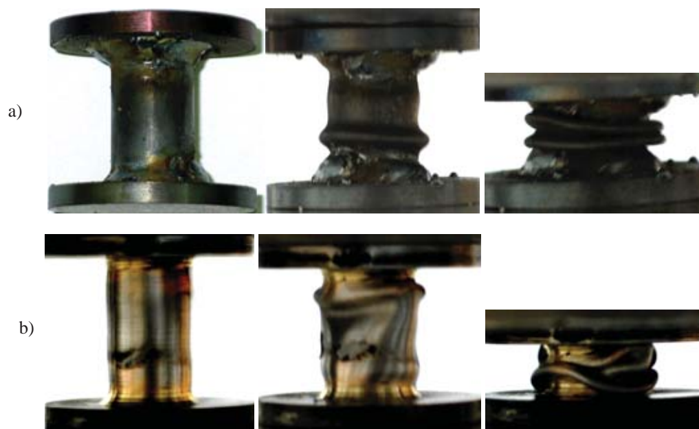
Rys. 1. Przebieg procesu ściskania rurek ze spoiną ciągłą wykonaną ze stali (a) i mosiądzu (b)
