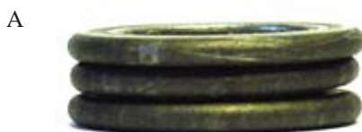
Rys. 2. Postać deformacji próbki o końcach swobodnych (A) Fig. 2. Deformation mode of free edge specimen (A)
